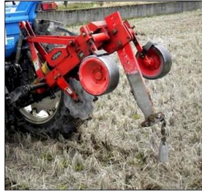
サブソイラによる心土破碎
